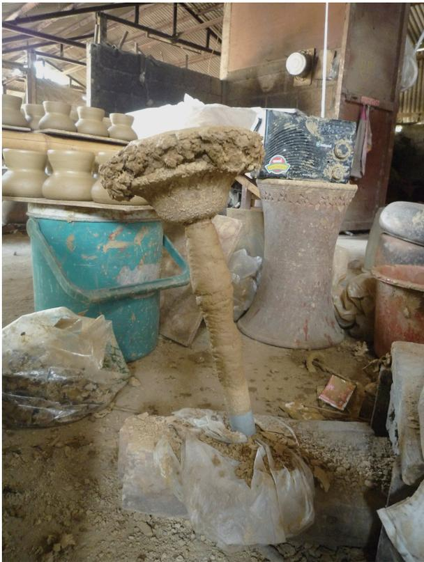
写真1 斜軸方向に小型の回転台が設置された状況
